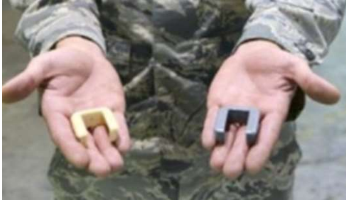
Abbildung 33: 3D-gedruckte Abdeckung für die Armlehnen der Boeing E-3 (Quelle: 3ders.org)
