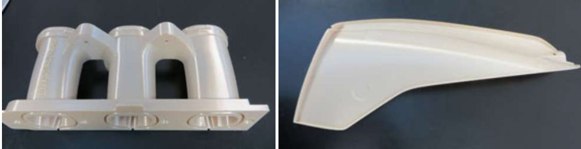
Abbildung 12: 3D-gedruckter Luftansaugkanal für einen Motor und Ellbogenstütze (Quelle: Stratasys)
