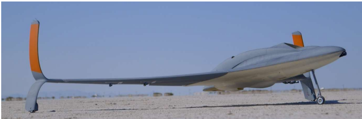
Abbildung 9: Weltweit erste FDM-gedruckte Drohne (Quelle: Business Wire)
