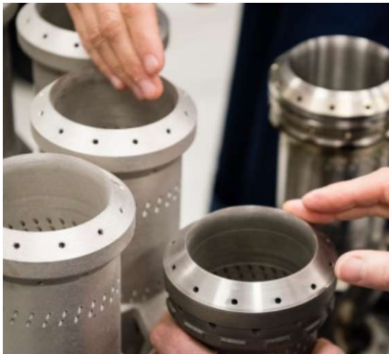
Abbildung 13: 3D-gedruckte Bauteile einer Gasturbine (Quelle: Siemens AG)
