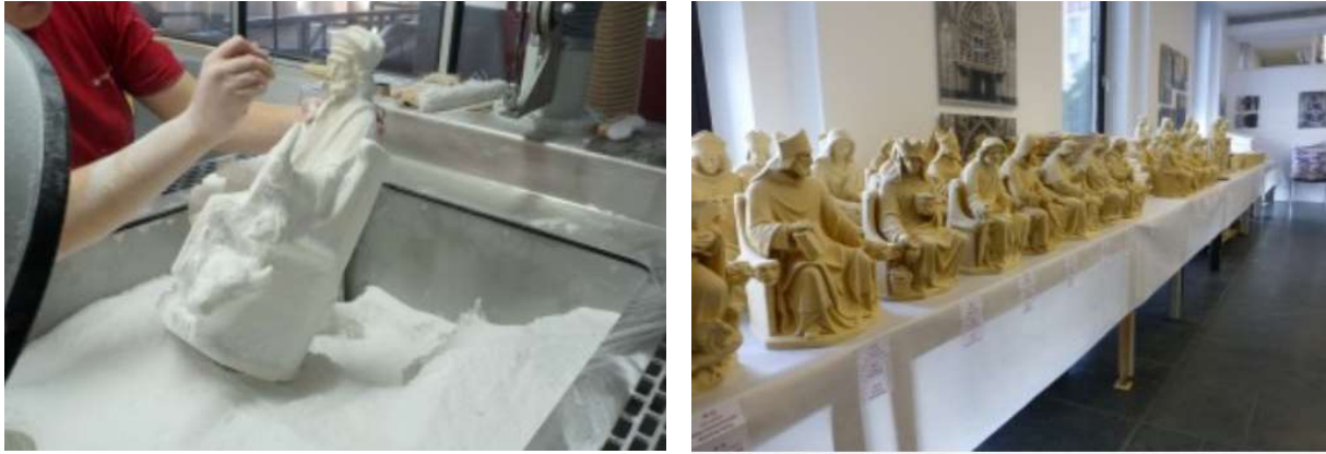
Abbildung 26: Produktion von 3D-gedruckte Repliken (Quelle: 3DION)
