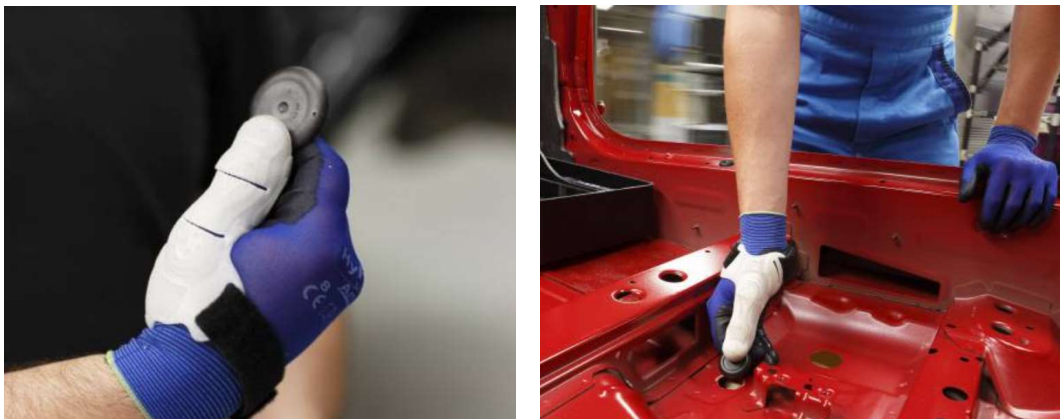
Abbildung 10: Individuelle Orthesen für die Fahrzeugmontage (Quelle: BMW Group)
