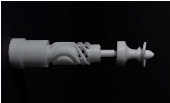
Abbildung 36: 3D-gedruckte Herzkatheter-Pumpe (Quelle: Lithoz)
