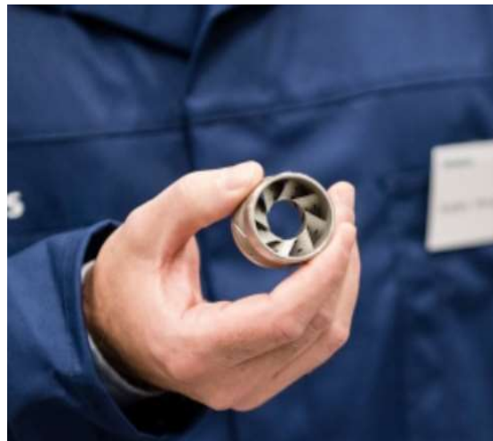
Abbildung 13: 3D-gedruckte Bauteile einer Gasturbine (Quelle: Siemens AG)
