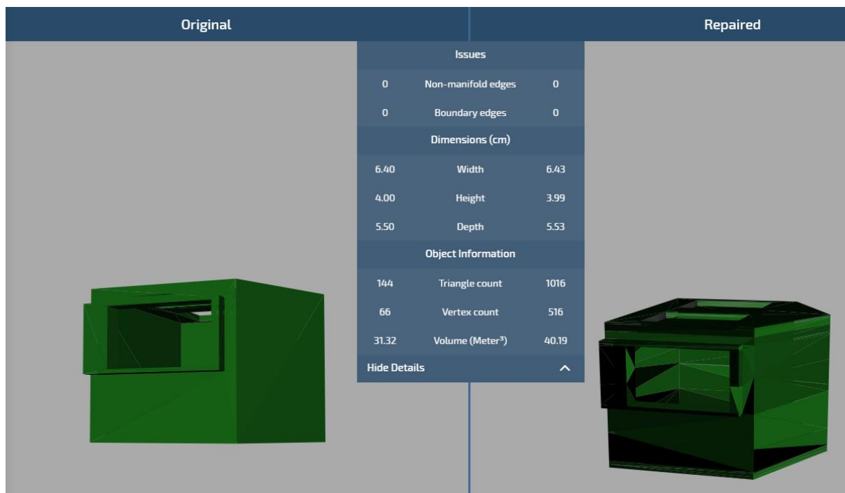
Abbildung 9: Ergebnis der Reparatur
