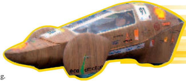
hydrokultur in der Urban-Concept-Klasse. Dabei vereinen sich die Konstruktionen und das Know-How aus Merseburg mit dem natürlichen Design und den Materialien der Burg und dem Wasserstoff-Brennstoffzellenantrieb aus Chemnitz zu einem wettbewerbsfähigen Fahrzeug für den Shell Eco-marathon. Wie das Fahrzeug, verändert sich auch das Team in jedem Jahr. Und so freuen sich die Teammitglieder immer auf neue interessierte Leute mit guten Ideen.
