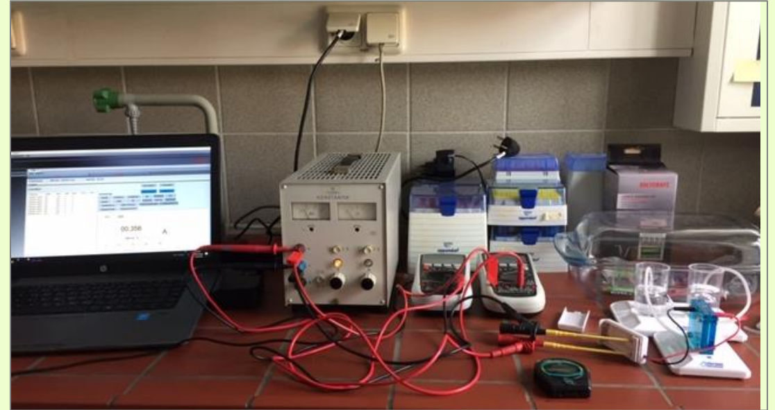
Abbildung 12: Versuchsaufbau – Computer für Datenverarbeitung, Stromversorgungsgerät, Messgeräte zum Aufnehmen der Spannung/ Stromstärke, reversible PEM-Brennstoffzelle mit Vorratsbehältern für Produktgase
