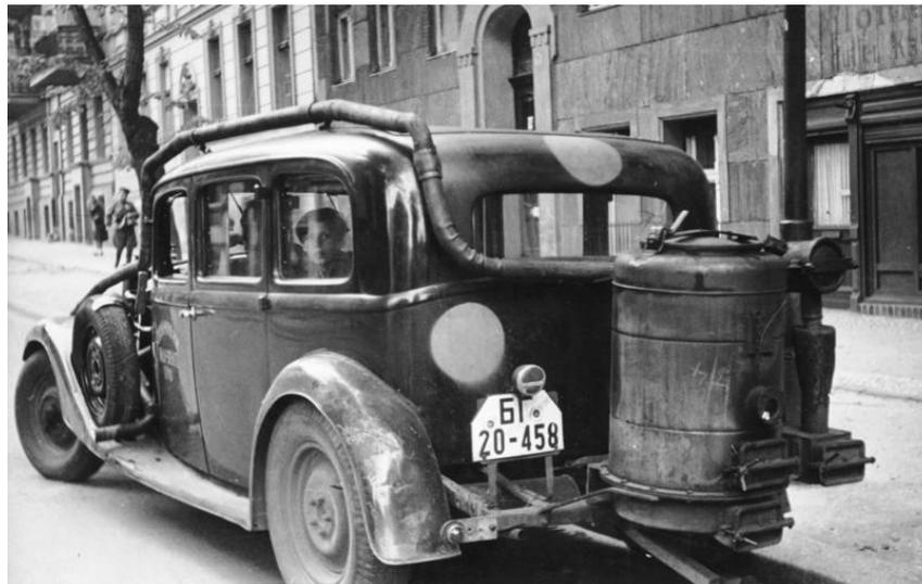
Abbildung 4: Automobil mit Holzvergaserantrieb. Quelle: Bundesarchiv, Bild 183-V00670A / CC-BY-SA 3.0 (Creative-Commons-Lizenz „Namensnennung - Weitergabe unter gleichen Bedingungen 3.0 Deutschland“)
